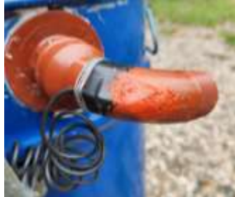
Salida con el bulbo del termómetro adentro.
