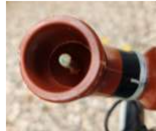
Vista de bulbo del termómetro dentro de la curva plástica.
